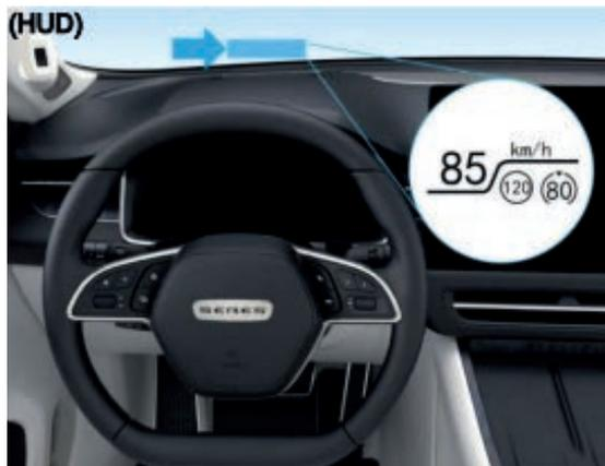
HUD se vincula con el cuadro de instrumentos digital y el sistema de navegación para proyectar información relevante en el área del parabrisas delantero mostrando información relevante al conductor que podrá consultar sin desviar la vista de la carretera o la atención en la conducción.
