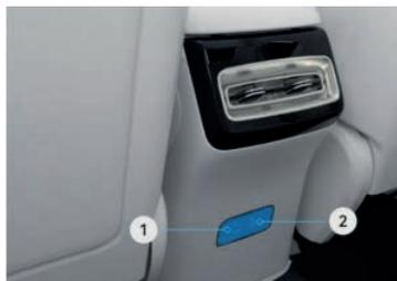
En la parte trasera del panel de instrumentos auxiliar (ver imagen) hay dos tomas de corriente para cargar dispositivos móviles.
