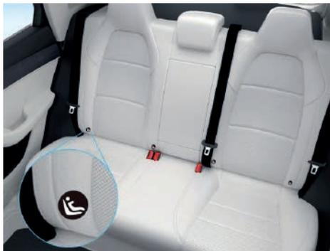
El dispositivo ISOFIX está ubicado en el asiento trasero y la marca ISOFIX está impresa en la posición del dispositivo.
