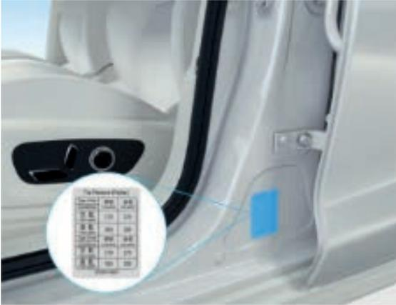
La etiqueta con la identificación de neumáticos homologados por el fabricante y la presión recomendada se encuentra debajo del pilar B, en el lado del conductor.
