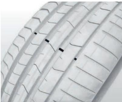
La marca de desgaste de la banda de rodadura del neumático es una línea de elevación estrecha que pasa a través de la ranura longitudinal del dibujo de la banda de rodadura del neumático. Hay un ícono de marca de desgaste de la banda de rodadura en un lado del neumático. Cuando la banda de rodadura tenga la misma altura que la marca de desgaste de la banda de rodadura, reemplace el neumático por uno nuevo lo antes posible.
