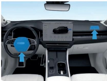
El airbag frontal del conductor está instalado en el volante y el airbag frontal del acompañante en el panel de instrumentos encima de la guantera, con el área de instalación marcada con "AIRBAG".
