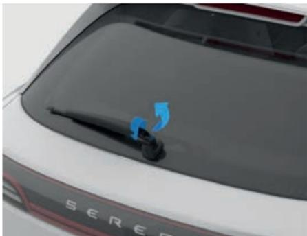
La posición del lavaparabrisas se establece en fábrica y no requiere ajustes adicionales. Si el lavaparabrisas está bloqueado, elimine la obstrucción de la boquilla con una herramienta.
