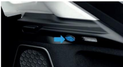
Los equipos electrónicos (p. ej., refrigerador de a bordo e inflador de a bordo) se pueden alimentar a través de la toma de corriente de 12 V en el maletero.
