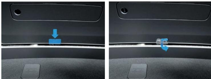
En caso de emergencia, puede abrir el maletero desde el interior del vehículo con un método mecánico.
