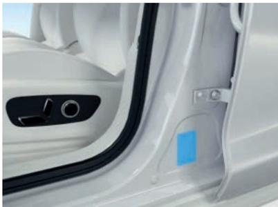
Compruebe la presión de los neumáticos con frecuencia, especialmente antes de realizar viajes largos. Asegúrese de inflar un neumático a la presión especificada en la etiqueta de presión de neumáticos.
