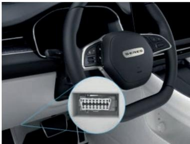
Conecte el conector OBD en el aparato de diagnóstico especial de SERES a la interfaz de diagnóstico OBD ubicada en la parte inferior del panel de instrumentos del conductor, y el aparato de diagnóstico podrá leer el código VIN del vehículo.
