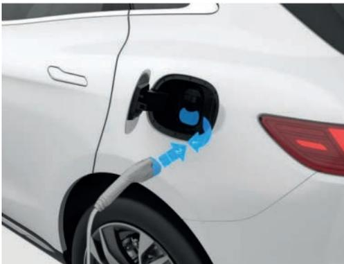
La salida de 220V CA se puede lograr a través del puerto de carga lenta y el conector V2L, que se utiliza como fuente de alimentación para electrodomésticos como iluminación, hornos de baja potencia y hornos microondas, con una potencia máxima de hasta 3,3 kW.
