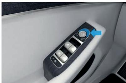
Al estacionar o conducir en un espacio estrecho, el espejo retrovisor exterior se puede plegar. El espejo retrovisor exterior permanecerá automáticamente en posición completamente plegada cuando se presione el botón indicado en la foto.
