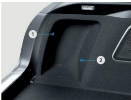
Si la tapa del puerto de carga no se abre o la función de desbloqueo del enchufe de carga falla, se puede usar el cable de desbloqueo de emergencia para abrir la tapa del puerto de carga y desbloquear el terminal de carga. El cable de desbloqueo de emergencia se encuentra en el lado izquierdo del maletero
