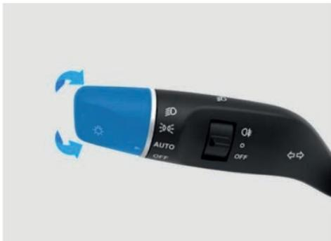
Gire el extremo de mando de ajuste de luces a la izquierda del volante para ajustar la luz de posición y el faro.
