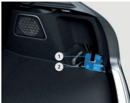
Las herramientas del conductor incluyen: triángulo de emergencia, chaleco reflectante, kit compresor, tanque de sellador de neumáticos y anillo de remolque.
