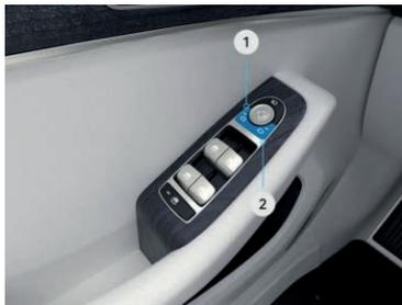
Puede utilizar el botón de ajuste del espejo trasero exterior en la puerta del conductor para ajustar la zona de visión.
