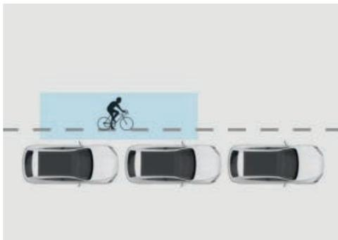
El sistema DOW funciona a través de los sensores de asistencia al conductor situados a la izquierda y a la derecha del parachoques trasero. Cuando la puerta está a punto de abrirse durante el estacionamiento o a baja velocidad, monitorea el estado detrás del vehículo que puede poner en peligro la seguridad y da una alarma a los pasajeros mediante sonido e imagen para evitar posibles accidentes de seguridad.
