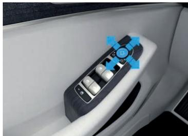
Después de presionar el botón de ajuste del espejo trasero correspondiente, ajuste el ángulo de visión del espejo seleccionado mediante el "joystick" circular indicado en la foto.
