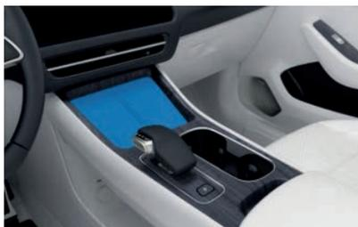
El teléfono móvil se carga de forma inalámbrica a través de la superficie de carga inalámbrica. Sitúe el dispositivo a cargar en la zona señalada en azul en la foto. El espacio está dividido para cargar dos terminales al mismo tiempo.
