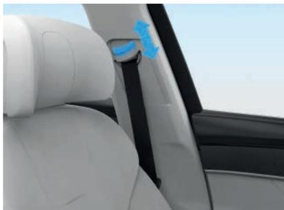
**Ajuste hacia arriba:** Levante el mecanismo de ajuste hacia arriba para ajustar la altura del cinturón de seguridad.
