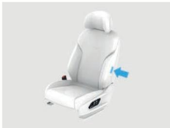
El airbag lateral del asiento delantero está instalado en el lado exterior del asiento delantero y está marcado con la palabra "AIRBAG".
