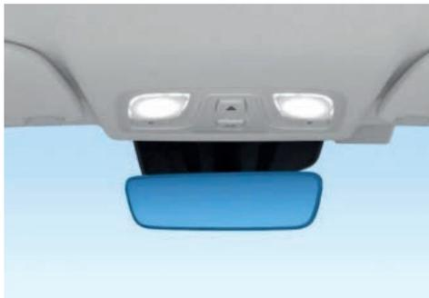
El espejo retrovisor interior equipado en el vehículo tiene una función antideslumbrante automática. Cuando recibe luz intensa desde (como las luces largas de un vehículo), el espejo trasero interior atenuará automáticamente el color de su superficie, disminuyendo así el impacto de la luz intensa sobre el conductor.
