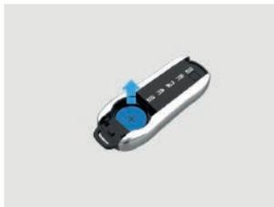
Si se ayuda de un objeto metálico o punzante, es necesario cubrir la cabeza con un trapo para evitar dañar la carcasa trasera del mando a distancia.
