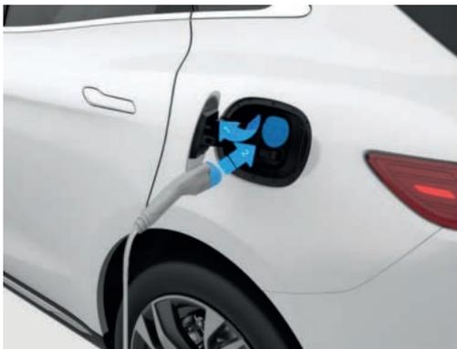
5. Retire la cubierta protectora del puerto de carga lenta y del enchufe de carga.
