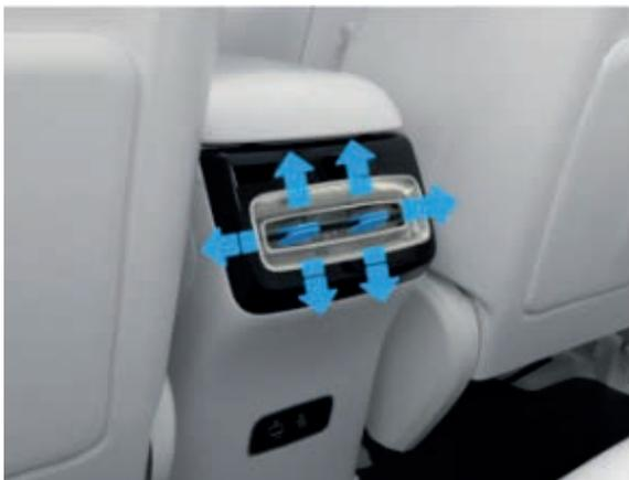
Mueva el panel de control hacia arriba, abajo, izquierda y derecha para ajustar la dirección de salida de aire trasera. Mueva el panel de control hacia el centro a la posición máxima para cerrar la salida de aire.
