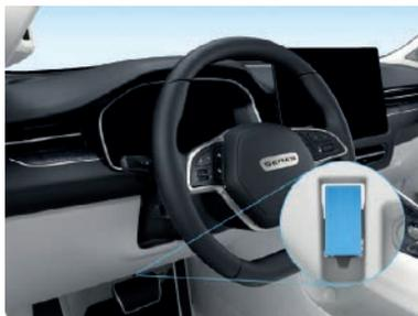
Tire de la manija de apertura en la parte inferior del salpicadero del lado del conductor dos veces seguidas, y el capó se desbloqueará automáticamente y se levantará hasta una cierta altura, luego levante el capó manualmente.
