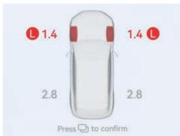
Puede seleccionar la interfaz de información de presión de los neumáticos a través del cuadrante de información del vehículo en el lado derecho de la pantalla de instrumentos para ver la presión de los neumáticos.
